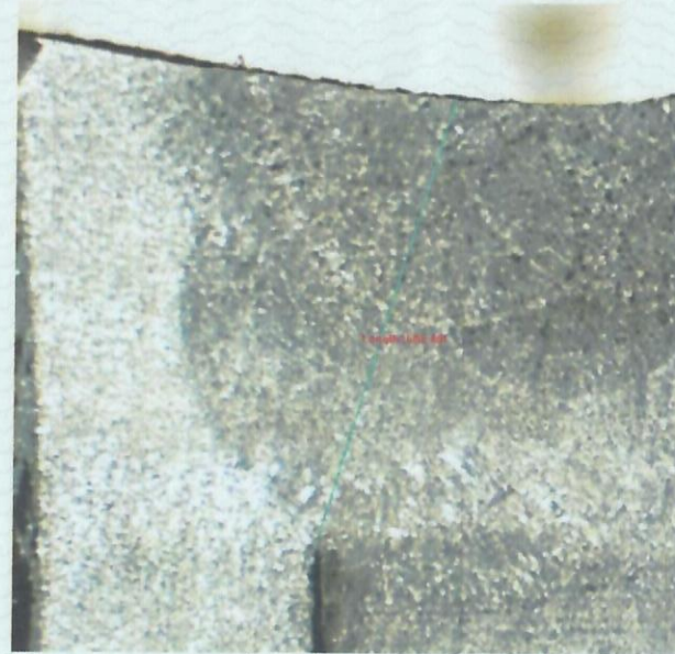
شکل 17. تصویر ماکروسکوپی از مقطع عرضی آماده سازی شده. (مقطع 17) محلول ظاهر کننده: نایتال ده درصد
