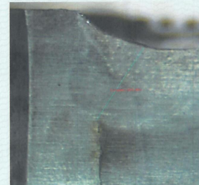
شکل 35. تصویر ماکروسکوپی از مقطع عرضی آماده سازی شده. (مقطع 35) محلول ظاهر کننده: نابتال ده درصد
