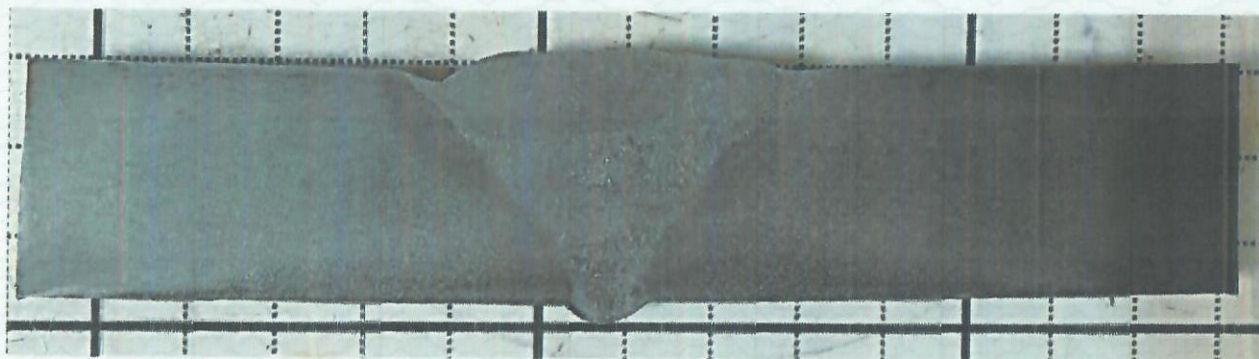
شکل ۱. تصویر ماکروسکوپی از مقطع عرضی آماده سازی شده. محلول ظاهر کننده؛ ناپثال ده درمید
