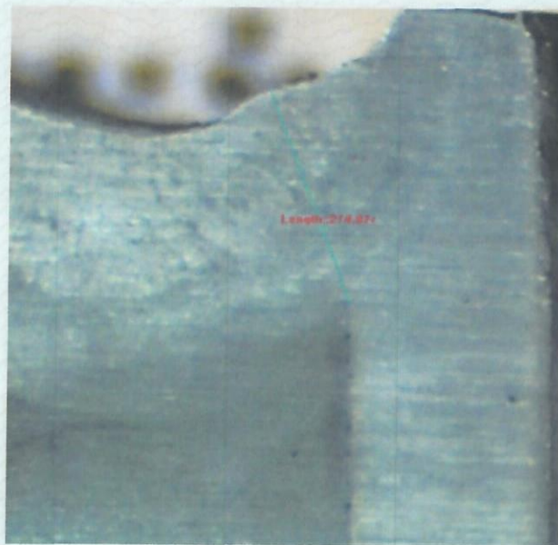
شکل 30. تصویر ماکروسکوپی از مقطع عرضی آماده سازی شده. (مقطع 30) محلول ظاهر کننده: نایتال ده درصد
